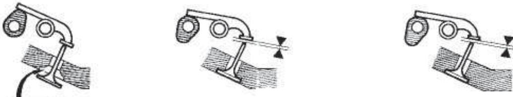
Para efetuar a regulagem de válvulas, coloque a válvula de escapamento do cilindro nº 1 na plena abertura, regule a folga da válvula de admissão do cilindro nº 3 e a folga da válvula de escape do cilindro nº 4, para as demais proceder conforme tabela abaixo:
