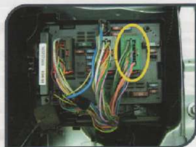
Conector E do C.V.M. Vista da parte superior da central
