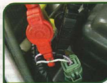
F.1.2-Medição da tensão de resposta
