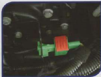
Terminal elétrico do sensor HEGO
