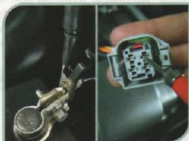
F.2.1-Tensão de alimentação da DIS
