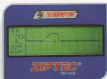
Sinal do potenciômetro 1 após o acionamento total do pedal do acelerador
