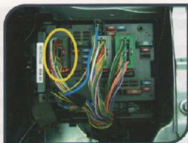
Conector B do C.V.M. Vista da parte superior da central
