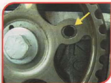
F5-Orifício da polia do comando alinhado com o orifício do cabeçote
