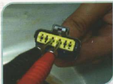
F.3.1-Medição da tensão de alimentação da bomba
