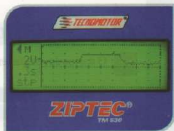
Sinal de resposta do sensor de pressão após uma aceleração
