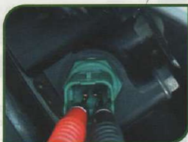
F.3.1-Resistência do sensor ECT
