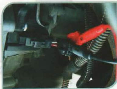
F.1.2-Tensão de resposta do sensor CKP (durante a partida)
