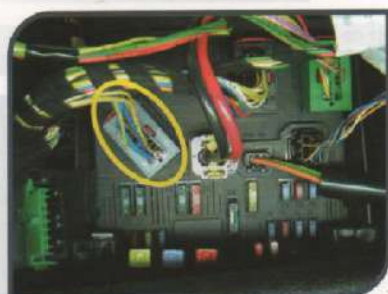
Conector F da central de relés e fusíveis do painel - B.C. Vista frontal da central
