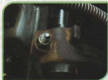
F3-Parafuso de fixação da torre de suspensão
