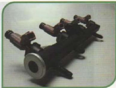
Tubo distribuidor e eletroinjetores
