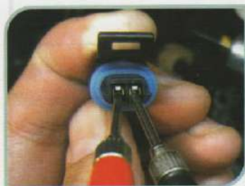
CH: Pontas de prova no conector elétrico do chicote do componente
