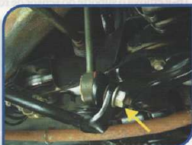
F9-Fixação das bieletas na barra estabilizadora
