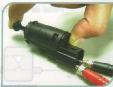
F.2.1-Resistência elétrica do componente para pedal de freio não pressionado.
