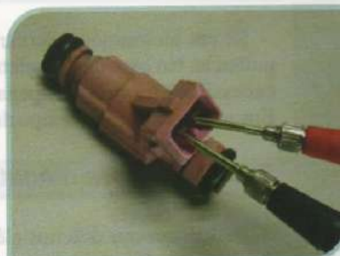
F.1.1-Teste da resistência do eletroinjetor
