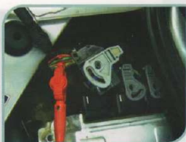
F.1.1-Pontas de prova no terminal C do MC
