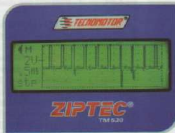
Sinal de frequência de acionamento do motor CC em marcha lenta
