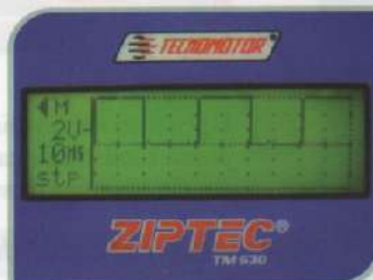
Sinal do sensor de velocidade (VSS tipo Hall) para a velocidade de 20 km/h
