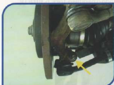
F8-Fixação do pivô à manga de eixo
