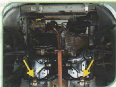
F9-Buchas de fixação da barra estabilizadora ao quadro da suspensão
