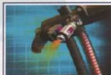
Injetor com pulverização normal
