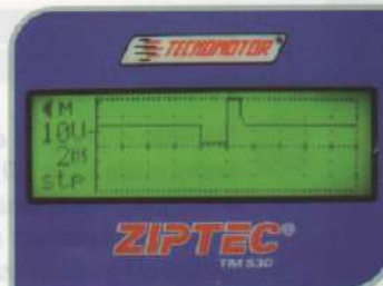
Sinal do pulso de acionamento da bobina de ignição em marcha lenta
