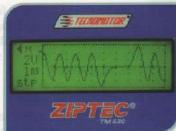
Sinal do sensor de posição da árvore de manivelas (CKP) em marcha lenta
