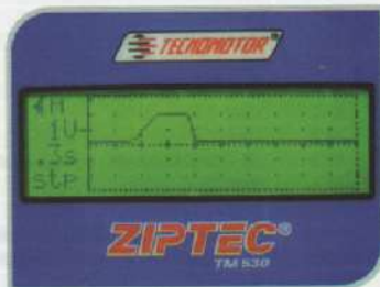
Sinal do potenciômetro 2 após o acionamento total do pedal do acelerador
