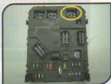
Conector C da central de relés e fusíveis do painel - B.C. Vista frontal da central
