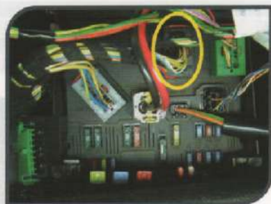
Conector D da central de relés e fusíveis do painel - B.C. Vista frontal da central
