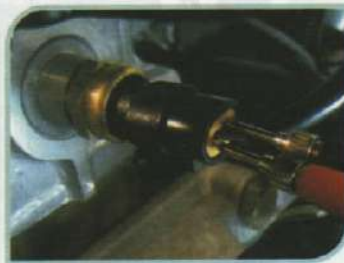
FIO: Pontas de prova nos fios de entrada do conector elétrico, plugado ao componente
