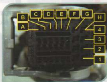
Terminal elétrico C do MC
