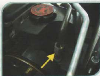
F2-Conexão da mangueira de pressão da bomba
