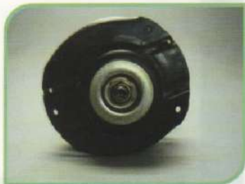
F5-Porca de fixação do amortecedor
