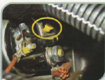
Terminal elétrico B+ do motor de partida
