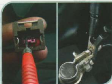
F.2.1-Tensão de alimentação da CANP
