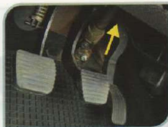
Localização do sensor de posição do pedal do acelerador - SPA
