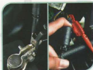
F.1.1-Tensão de resposta para o pedal de freio não pressionado.
