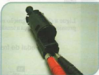
F.2.2-Resistência elétrica do componente para pedal de freio pressionado.
