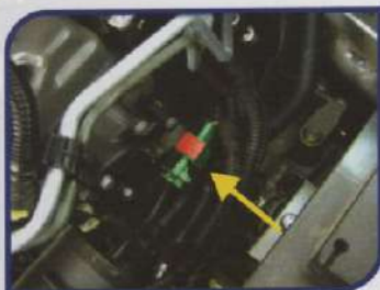
Localização do terminal elétrico do sensor HEGO, fixado ao lado do bloco
