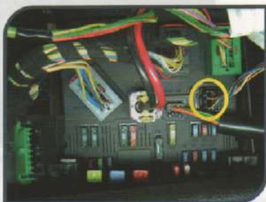
Conector I da central de relés e fusíveis do painel - B.C. Vista frontal da central
