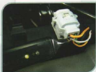
F.3.1-Verificação dos pulsos de aterramento
