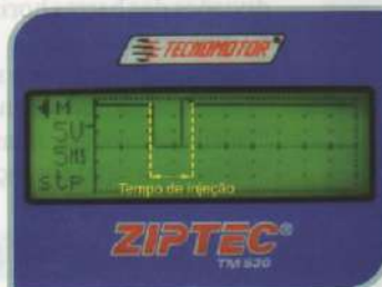
Sinal do pulso de acionamento do eletroinjeter em marcha lenta.
