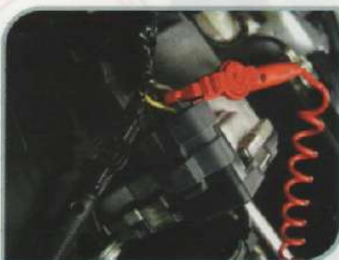
F.1.2-Medição da frequência de acionamento do motor elétrico do ETC
