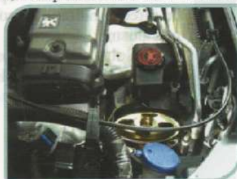
F4-Reservatório localizado sobre a bomba
