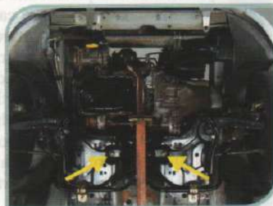
F8-Parafusos de fixação da caixa de direção
