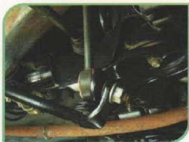
F8-Fixação da bieleta na barra estabilizadora
