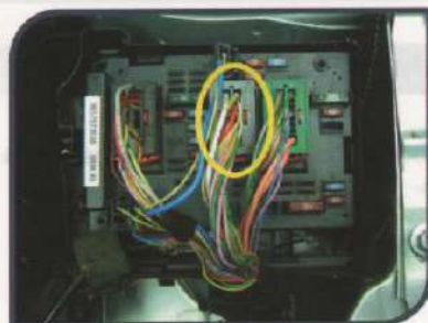
Conector D do C.V.M. Vista da parte superior da central
