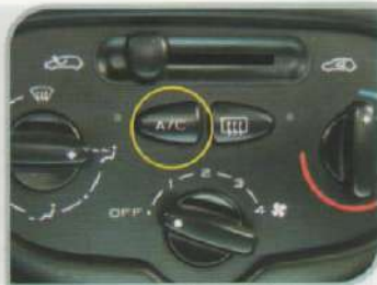
Seletor de controle do ventilador interno conjugado com o interruptor do A/C
