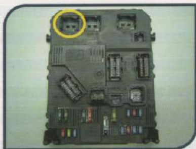
Conector A da central de relés e fusíveis do painel - B.C. Vista frontal da central
