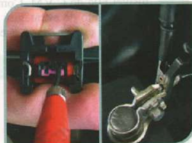
F.2.1-Medição da tensão de alimentação da VCC
