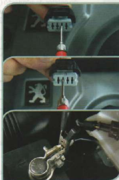
F.3.1-Tensão de alimentação do sensor
