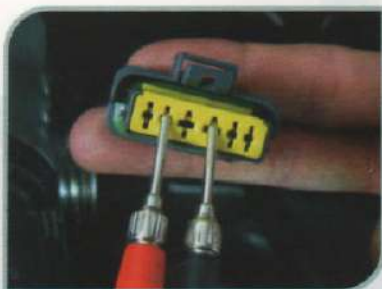
F.2.1-Medição da tensão de alimentação
