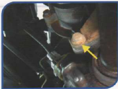
F11-Parafuso traseiro de fixação da transmissão
