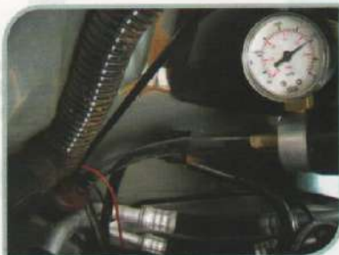
F.1.1-Bomba de pressão conectada à saída da CANP
