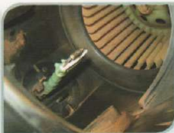
Resistência do ventilador interno
