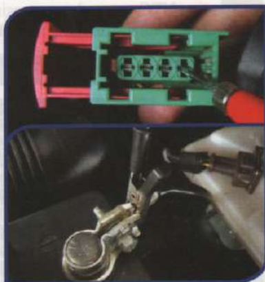
F.2.1-Tensão de alimentação do sensor HEGO
