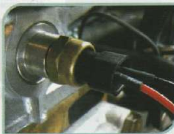
CP: Pontas de prova nos terminais elétricos do componente
