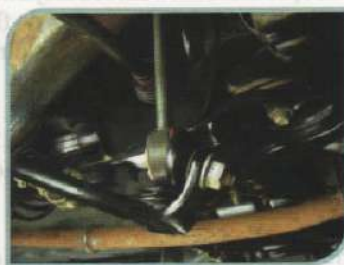
F6-Parafuso de fixação da bieleta
