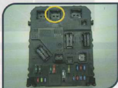
Conector B da central de relés e fusíveis do painel - B.C. Vista frontal da central
