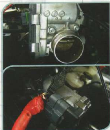
F.1.1-Medição da resposta de tensão dos potenciômetros do ETC
