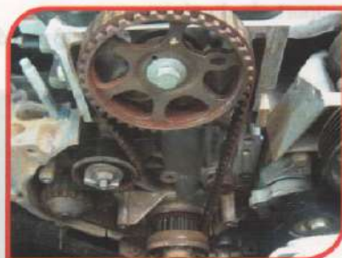
F6-Correia dentada usada
