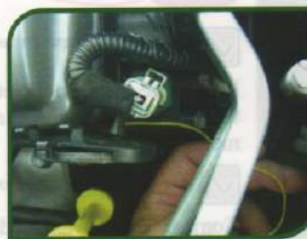
F.1.1-Medição da temperatura do motor
